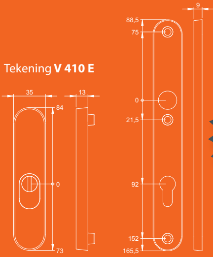
V 410 E rozet met kerntrekbeveiliging/incl. binnenschild
